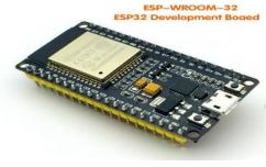
FIG. 8: ESP32 MICROCONTROLLER
