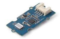
FIG. 4: MULTICHANNEL GROVE GAS SENSOR
