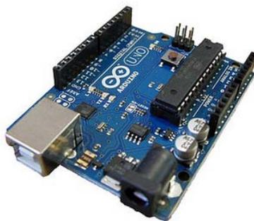
FIG. 3. ARDUINO UNO BOARD.
